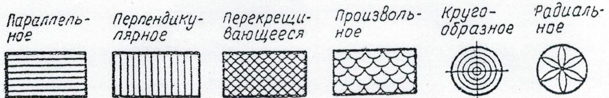
Направление неровностей при обработке и их условные обозначения на чертежах.
